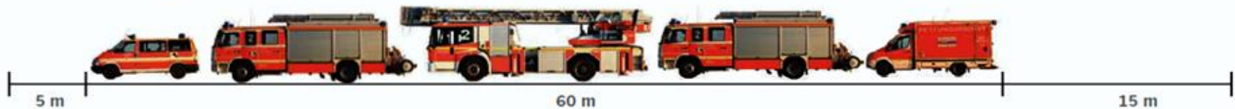
Platzbedarf bei größerem Einsatz für einen Löschzug
